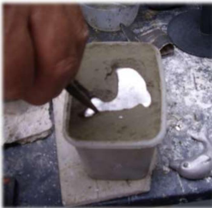
Una vez que se fundió el metal esperamos a que se enfrie a temperatura ambiente para obtener la pieza.
