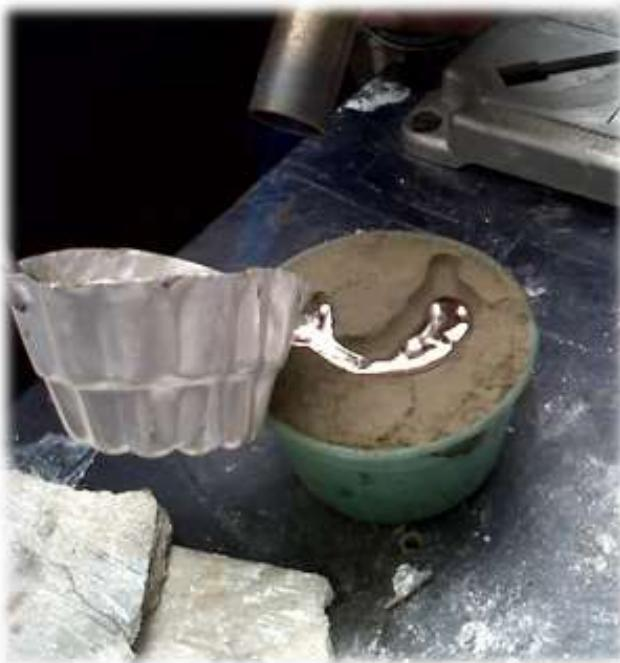
Se vaciará el metal rápidamente y se generará solamente por un área en especifica.
