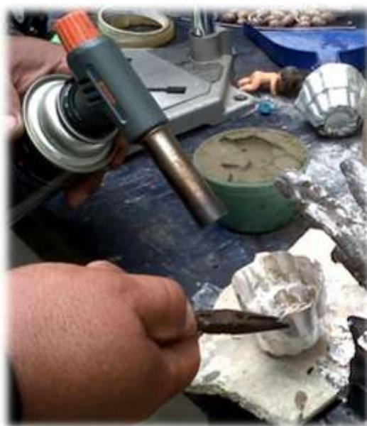
Fundir, se puede utilizar utilizando gas butano, propano, acetileno, lp, etc.
