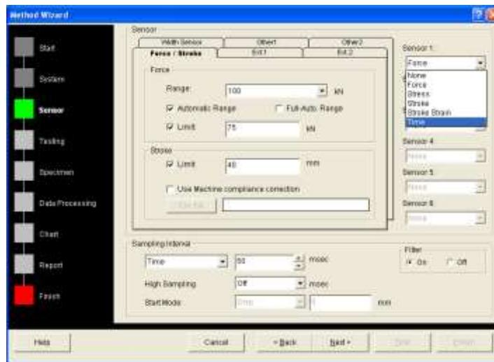
**Paso 4:** Esta ventana tiene mucha importancia a la hora de crear un nuevo método ya que se nos da la opción de escoger como se va a controlar la prueba, la velocidad de la prueba, cuando iniciar la prueba, qué hacer cuando se haya roto la probeta del material. En el caso de los polímeros se modificará la sensibilidad.
