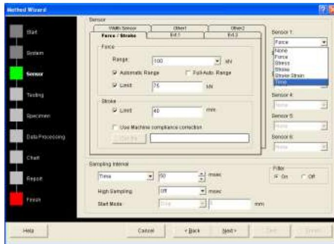
**Paso 4:** Esta ventana tiene mucha importancia a la hora de crear un nuevo método ya que se nos da la opción de escoger como se va a controlar la prueba, la velocidad de la prueba, cuando iniciar la prueba, qué hacer cuando se haya roto la probeta del material.
