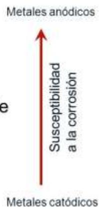
Conectando el metal que se trata de proteger a otro menos noble que él, es decir, más negativo en la serie electroquímica. **Este sistema se conoce como protección catódica con ánodos galvánicos o de sacrificio y consiste realmente en la creación de una pila galvánica en que el metal a proteger actúe forzosamente de cátodo (polo positivo de la pila), mientras que el metal anódico se "sacrifica", o sea que se disuelve.**
