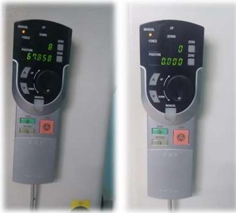
Para iniciar la prueba de compresión el encargado del taller o en su caso el personal de servicio social tiene que dar el visto bueno a la instalación de los aditamentos, verificar que la probeta este en la posición adecuada. Para dar paso a la prueba debemos de oprimir el botón de “start” entonces la prueba empezara a correr automáticamente, en este paso no debemos interferir con la máquina o el software a menos que se necesite un paro de emergencia o detener la prueba.
