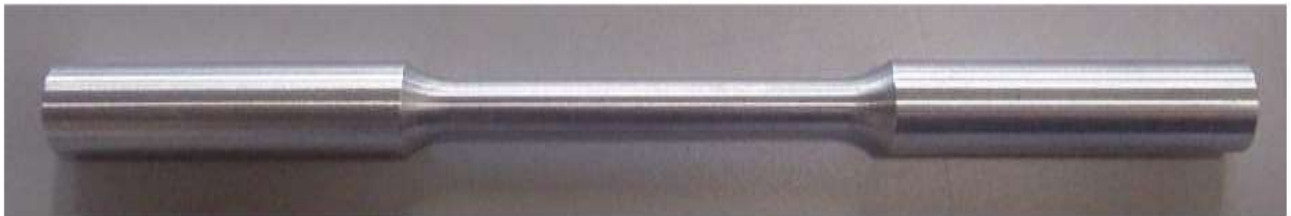
Dimensiones de las probetas para ensayo de tracción.
